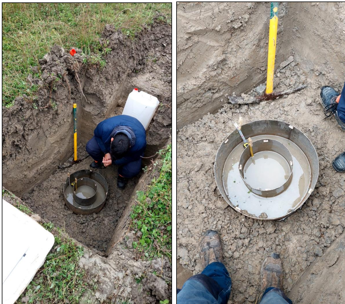
Figura 2.1.1: Esecuzione della prova con infiltrometro a doppio anello
